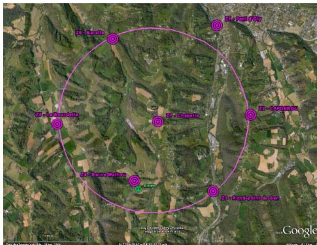
Configuration du réseau microsismique de Rousse (Image satellite Google Earth)
