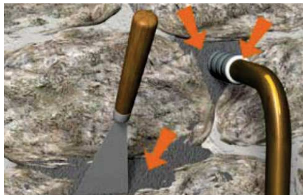
Situation après travaux de colmatage
