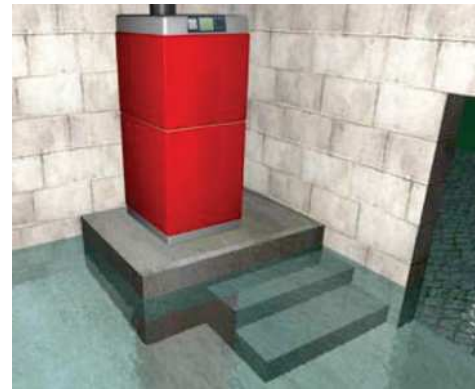
Exemple de mise hors d'eau des installations sensibles par surélévation
