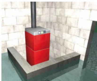
protection par disposition étanche
