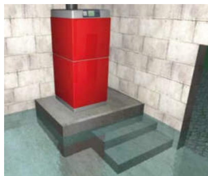
Mise hors d'eau par surélévation
