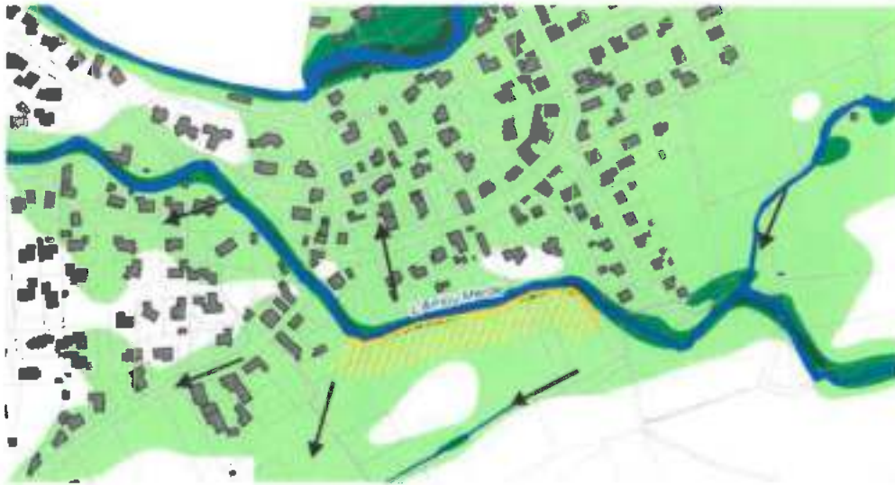
Figure 34 : Exemple de bande de sécurité (hachurage orange)
