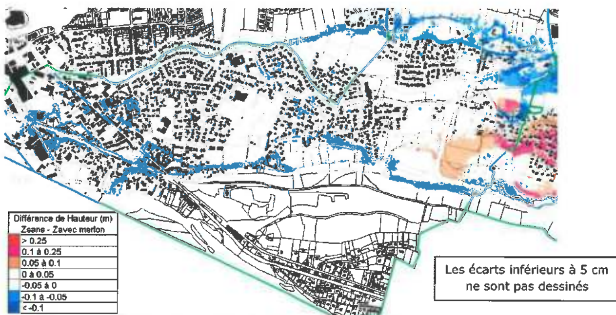
Figure 57 : Impact de la suppression des merlons à Bizanos
