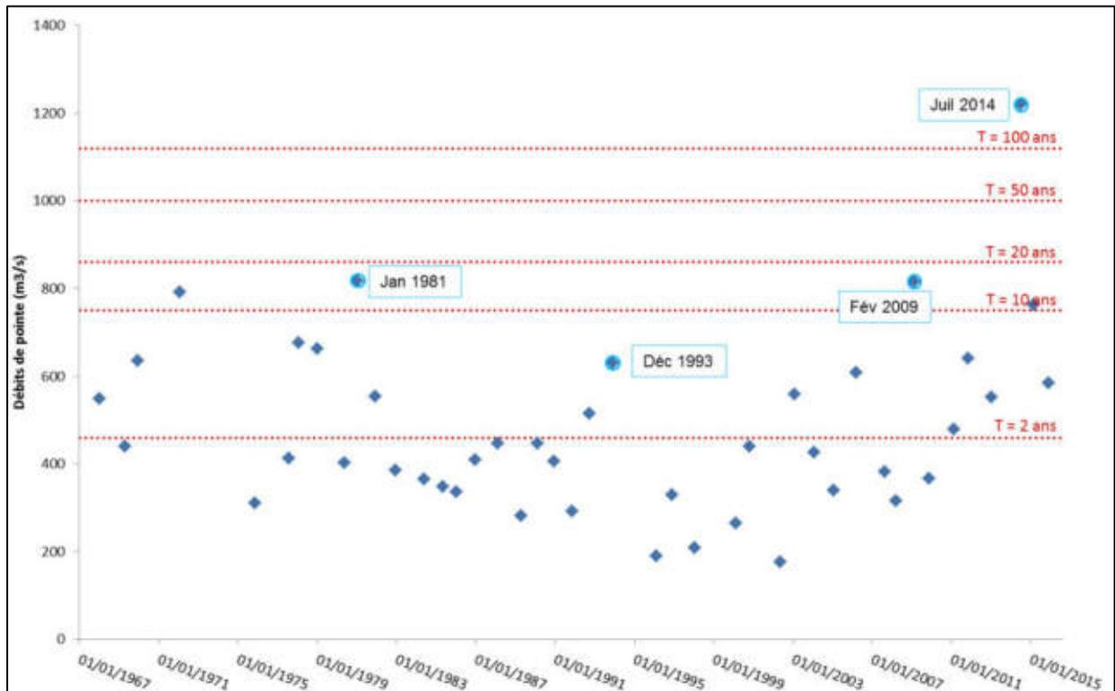
Figure 5 : Comparaison des débits de pointe des crues historiques avec les débits des crues de projet (Source : Crucal de la banque hydro)
