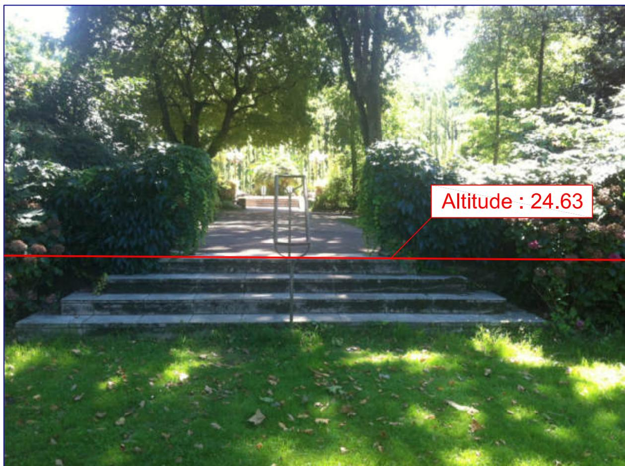
Le nivellement est rattaché au système NGF-IGN69.
