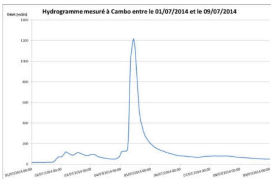
Figure 2 : Hydrogramme de la Nive mesuré à Cambo-les-bains en juillet 2014
