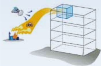
Local de confinement exposé au site industriel : à éviter
