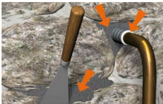
Situation après travaux de colmatage
