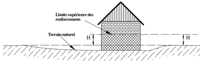
En cas de terrassements **en déblais**, la hauteur doit être mesurée par rapport au terrain naturel initial.
