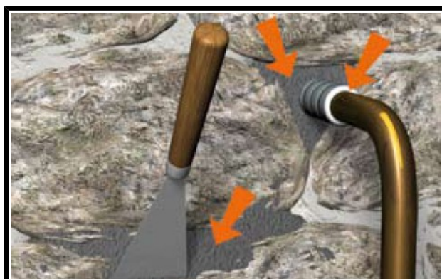
Situation après travaux de colmatage
