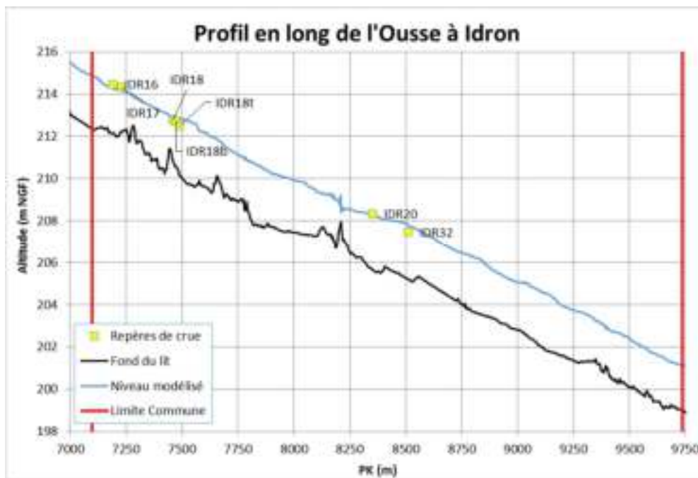
Figure 24 : Profil en long de calage du modèle sur la crue de janvier 2014 à Idron
