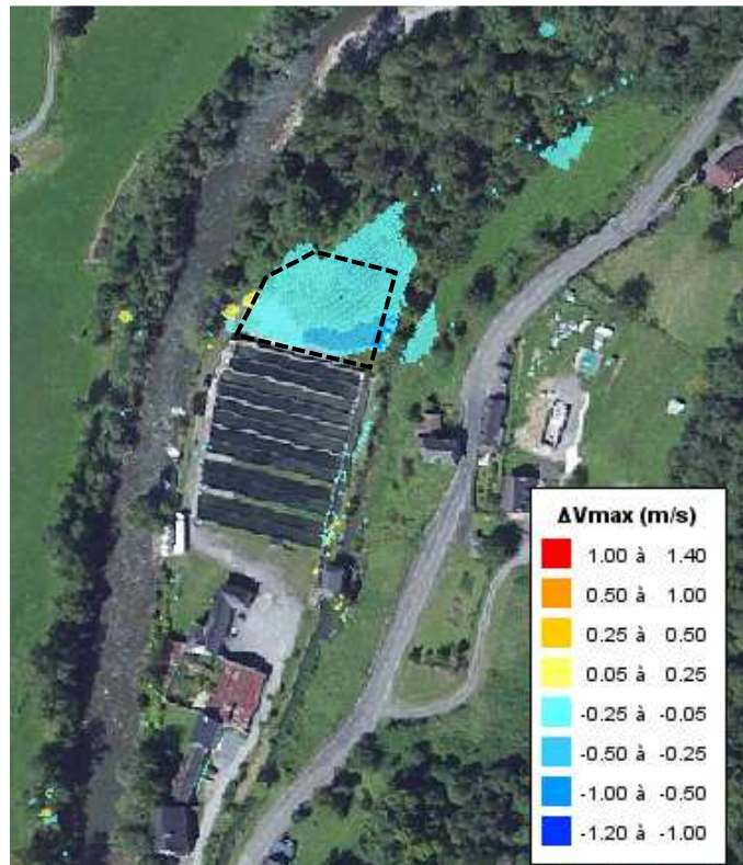
Figure 13 : Différence sur les vitesses pour la crue décennale (état aménagé / état actuel)
