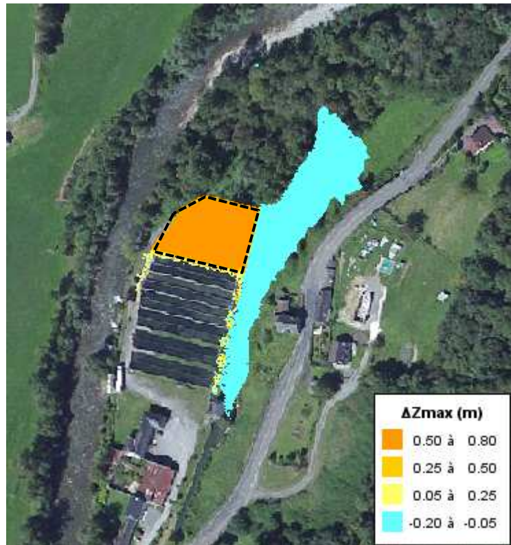
Figure 17 : Différence sur les cotes d'eau pour la crue de référence (état aménagé / état actuel)
