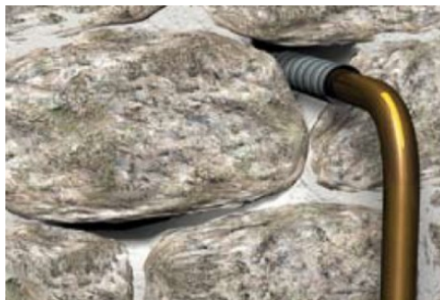
Situation initiale avant colmatage
