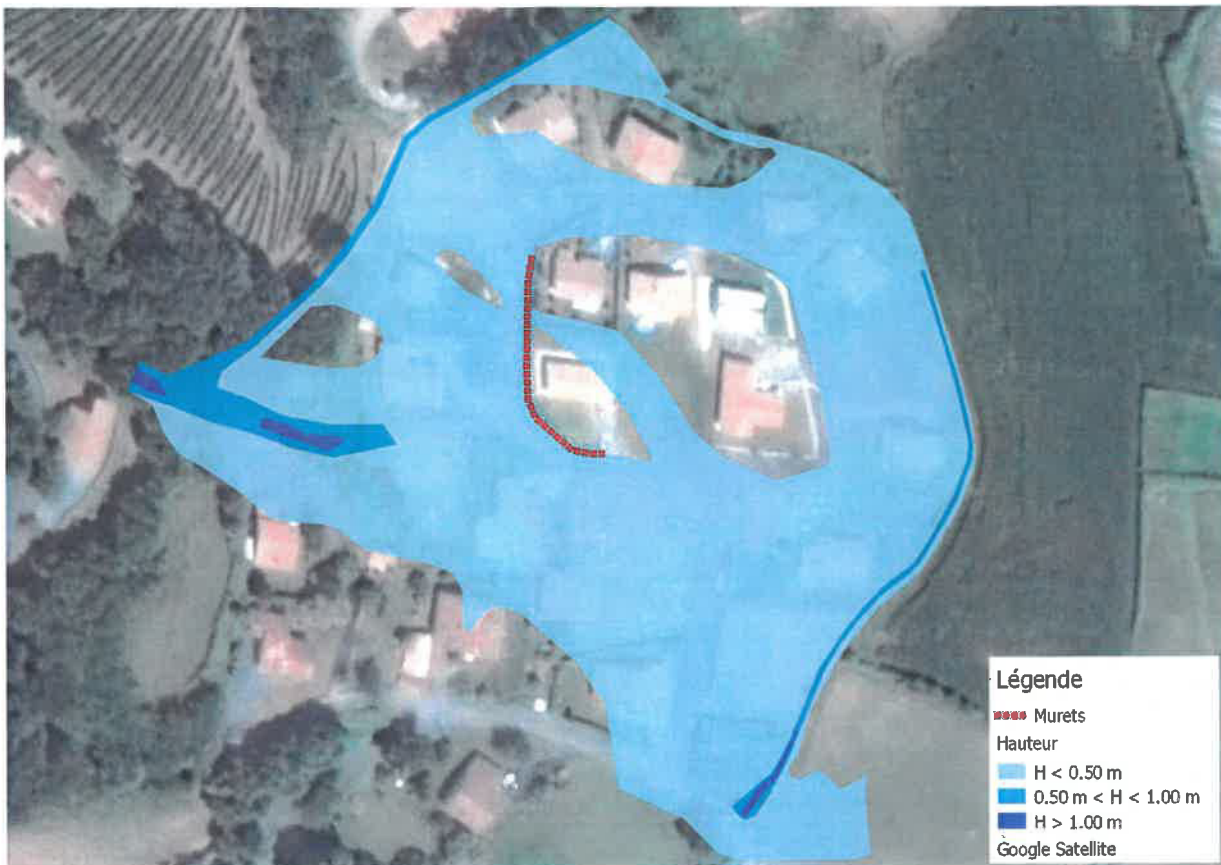
Figure 13 : Carte des hauteurs d'eau à dire d'expert avec prise en compte des murets au droit du lotissement Bordda
