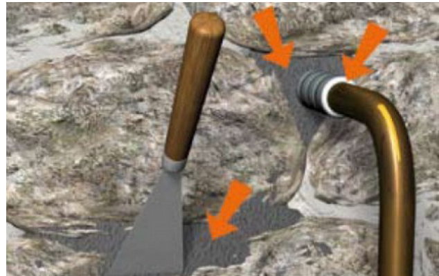
Situation après travaux de colmatage
