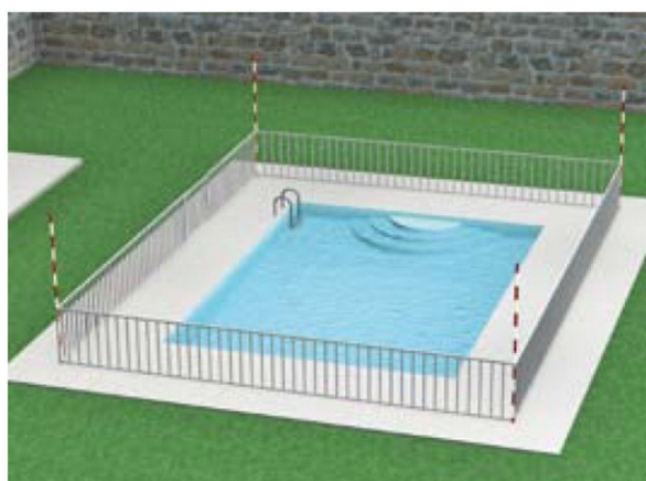
Piscine privée équipée d'une barrière de sécurité
