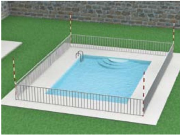
Piscine privée équipée d'une barrière de sécurité
