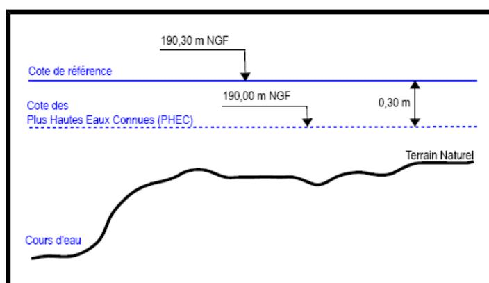
Les cotes de référence sont généralement associées à un profil en travers. Elles peuvent également être appliquées sur un secteur déterminé. Lorsqu'un projet de construction se situe entre deux profils en travers, la cote de référence à prendre en compte doit être calculée par interpolation. Elle est calculée par rapport à l'angle de la construction située le plus à l'amont.
