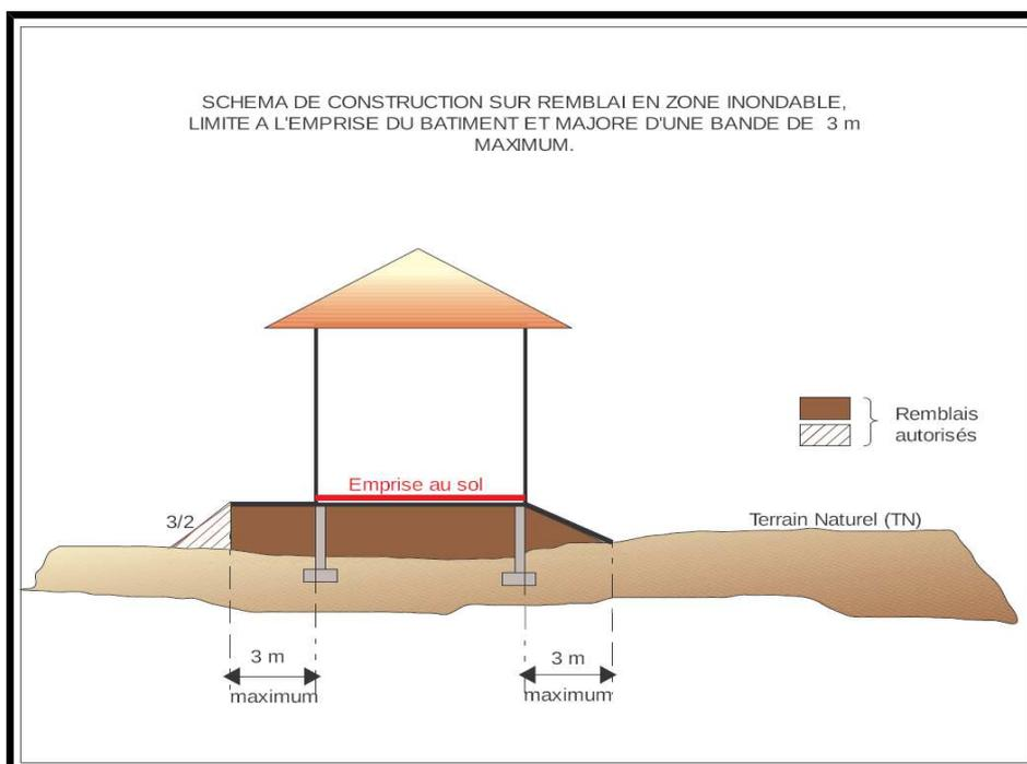
Afin de limiter l'effet d'obstacle, la plus grande longueur du bâtiment doit être placée dans l'axe des écoulements de l'eau. On évitera les décrochements importants au niveau de l'emprise de la construction (voir schéma ci-dessous)
