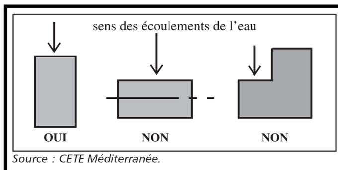
Le choix d'implantation d'un ensemble de constructions doit prendre en compte la nécessité de conserver une transparence hydraulique en ménageant des espaces libres pour l'écoulement. On tiendra compte du fait que le niveau de crue est rehaussé entre les bâtiments et que la vitesse du courant est augmentée dans les rétrécissements.
