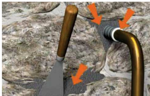
Situation après travaux de colmatage
