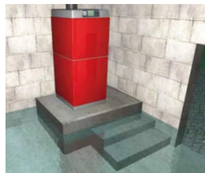
Mise hors d'eau par surélévation
