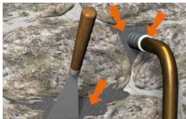
Situation après travaux de colmatage
