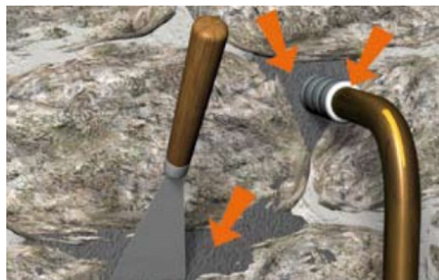
Situation après travaux de colmatage
