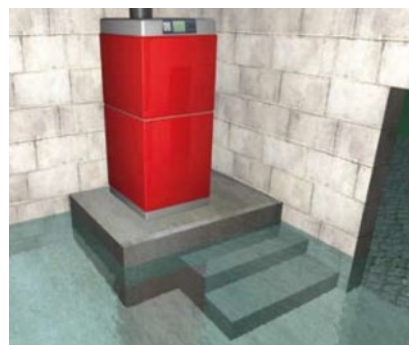
Mise hors d'eau par surélévation
